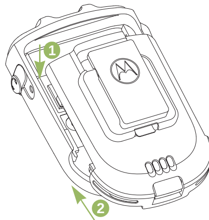
Figure 2.2 : Placement de la batterie dans le WRSM
