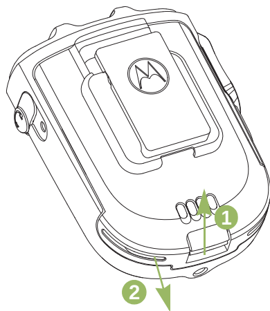
Figure 2.3 : Retrait de la batterie du WRSM
