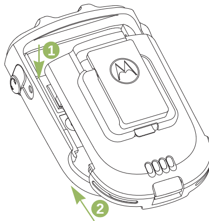
Figura 2.2: Inserimento della batteria nel WSRM
