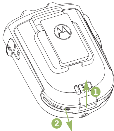
Abb. 2.3: Entfernen des Akkus aus dem WRS
